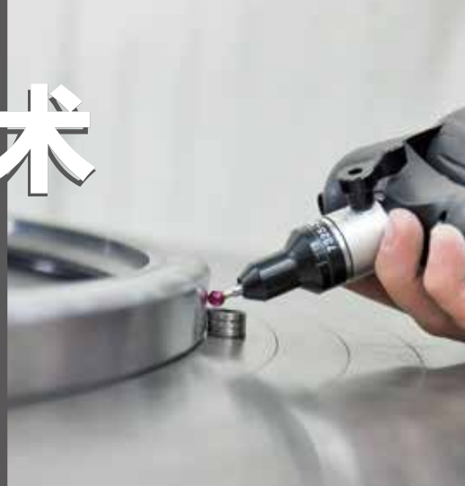
用拟人测量臂进行尺寸控制
